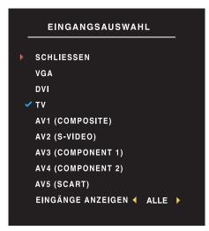
**VGA** – Wählen Sie diesen Eintrag, wenn der TV-Bildschirm als Computermonitor eingesetzt wird und mit einem VGA-Kabel an den Computer angeschlossen ist. Unter "Unterseite" auf Seite 8 wird die Position des VGA-Anschlusses gezeigt.
