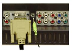
Ein digitales Signal, das digital unterstützt und analog in digital umwandelt. Für eine hoch auflösende Anzeige kann DVI verwendet werden. DVI unterstützt Auflösungen von bis zu 1280 x 768.
