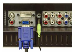
Ein Standard-Grafikanzeigesystem für Computer, die ein analoges Signal verwenden und Auflösungen von bis zu 1280 x 768 unterstützen können.
