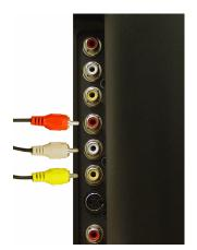
Beim Mischsignal wird das Videosignal (Bild) über einen Pol übertragen. Wenn Sie einen Mischsignalanschluss verwenden, müssen Sie auch Mischsignal-Audioanschlüsse verbinden. Die Position des Anschlusses wird auf Seite 7 gezeigt.
