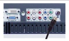
Koaxialkabel (HF) übertragen Bild und Ton gemeinsam. Der Koaxialanschluss ist am TV-Bildschirm mit ANT/Cable beschriftet. Die Position des Anschlusses wird auf Seite 8 gezeigt.
